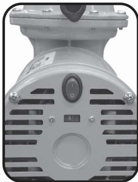
**4.6** Ao girar (abrir) a válvula reguladora de pressão, o motocompressor terá uma partida sem carga. Este procedimento deverá ser realizado toda vez que o motocompressor for ligado, evitando assim o travamento ou sobrecarga no motor. Após iniciado, feche a válvula e assim o motocompressor atingirá a pressão máxima de 40 lbf/pol<sup>2</sup> estando pronto para o trabalho.
